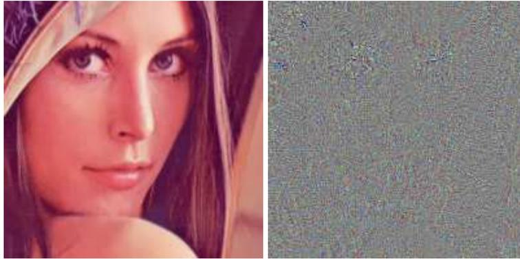
Figure 6: Dans cette expérience, on voit l'image Lena de la figure 3 débruitée par l'algorithme des moyennes non locales. L'image de droite montre ce qui a été enlevé à l'image originale par l'algorithme. Cette différence ressemble beaucoup plus à un bruit que les précédentes.
